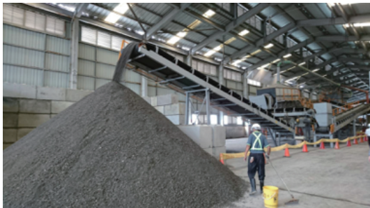
圖 15 焚化再生粒料廠內作業情形
