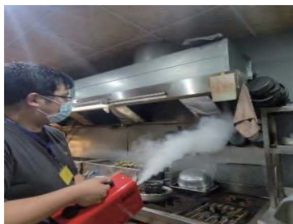
營建工程裸露區域鋪設防塵網抑制揚塵 / 使用科技儀器具象化煙流確認氣罩收集效果
