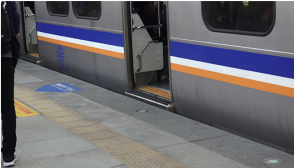
圖 13 臺鐵改造後車廂與月台無高度差
