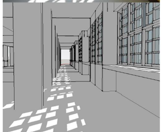
圖 3-71 電腦模擬最適照明與導風，降低依賴空調使用
