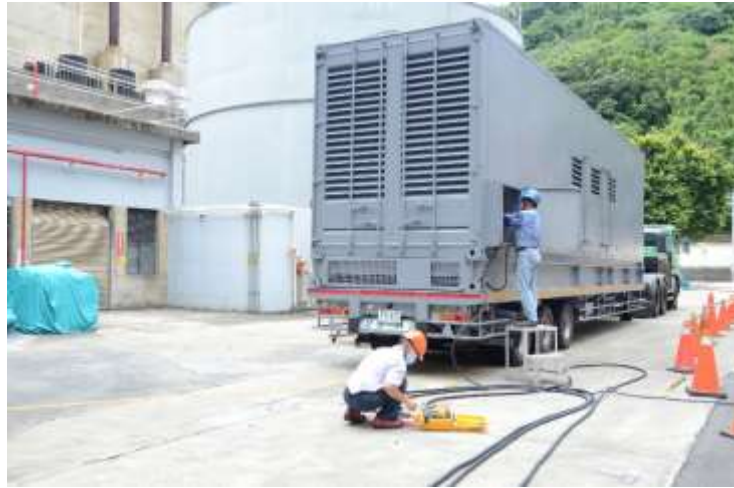
圖42 110年核能一廠4.16kV電源車引接演練
