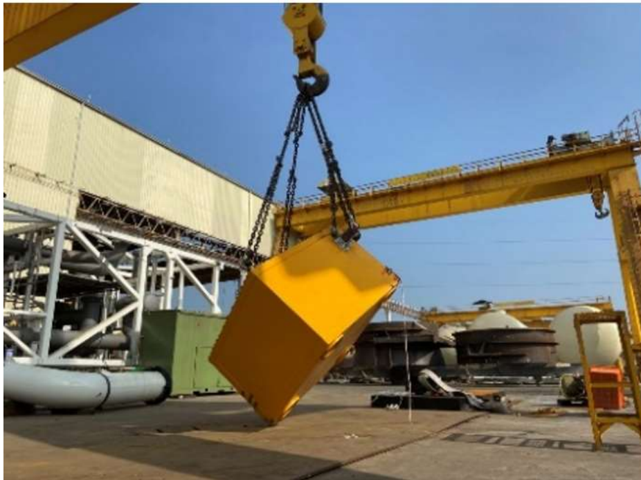
圖 27 核研所 INER-LRW-C2 型低放射性廢棄物盛裝容器安全性測試實景
