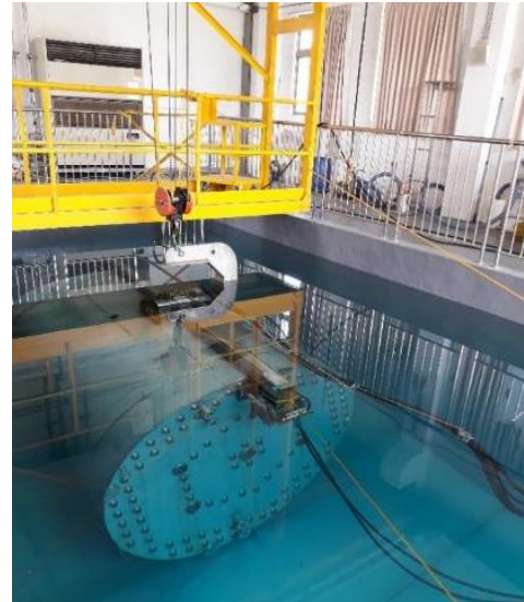
圖27、水下圓盤鋸切割測試作業
