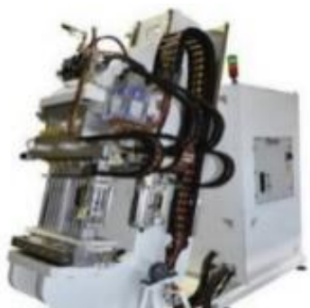
燃料電池模組堆疊與 自動化取放設備
