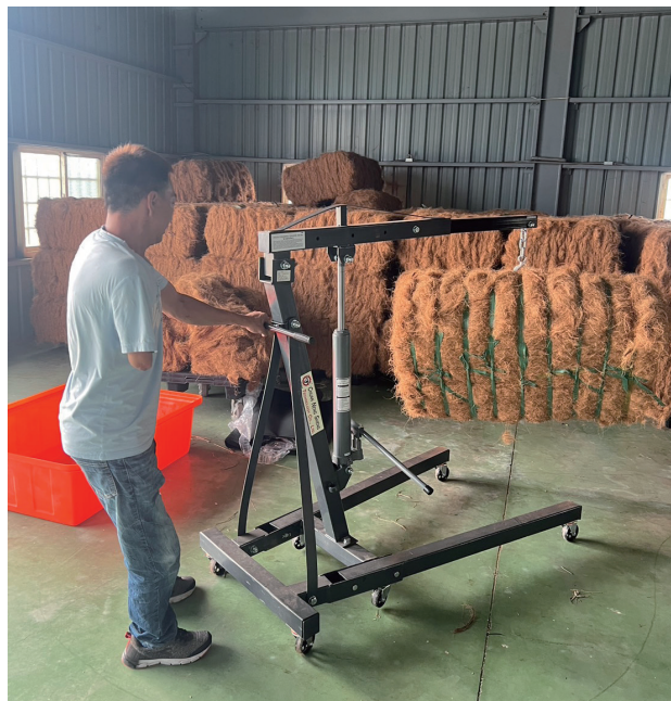
▲圖 2-22 透過職務再設計服務，補助移動式吊架，改善移動及搬運困難
