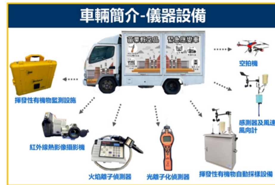
▲空品監測車設備
